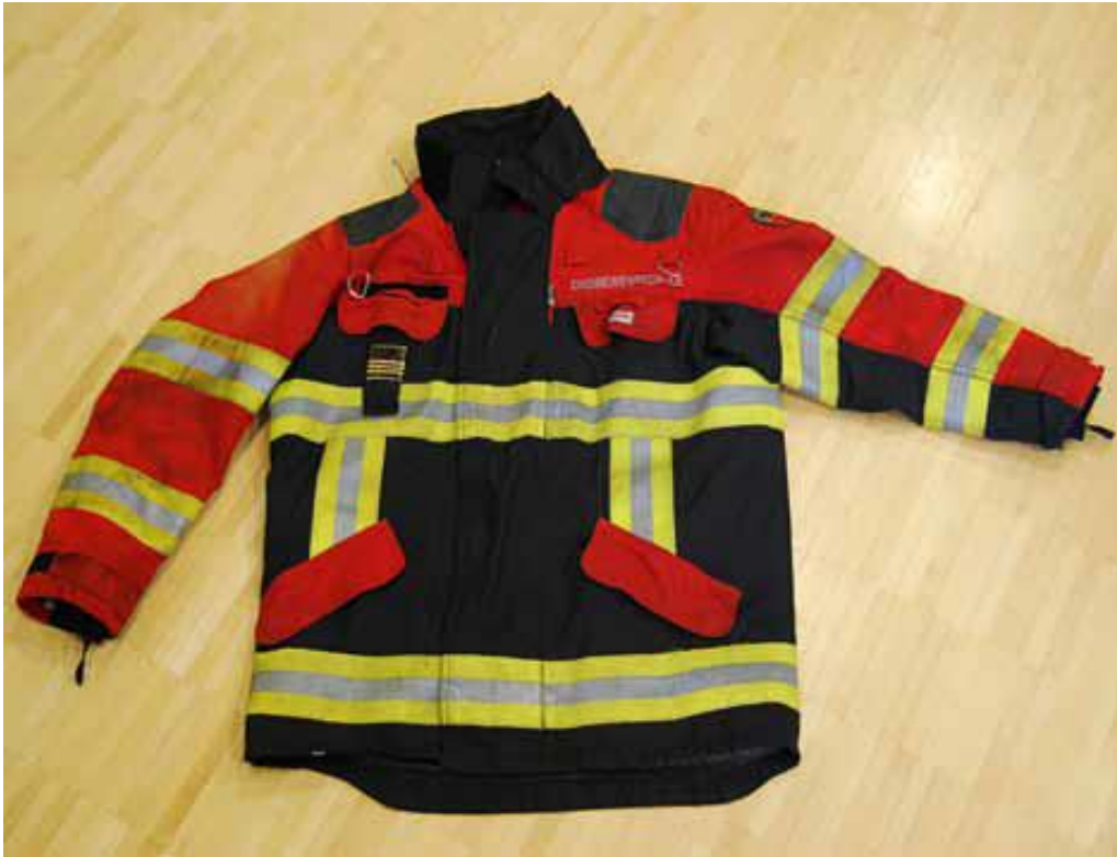
Bilder 7 : Diese Schutzjacke wurde 2007 in Betrieb genommen und bereits 50 Mal gewaschen. Trotzdem weist sie immer noch einen durchschnittlichen Retroreflexionskoeffizienten auf, der dreimal höher ist als das Minimum, welches von der gesetzlichen Norm verlangt wird, und gewährleistet so immer noch die Wahrnehmbarkeit des Trägers
